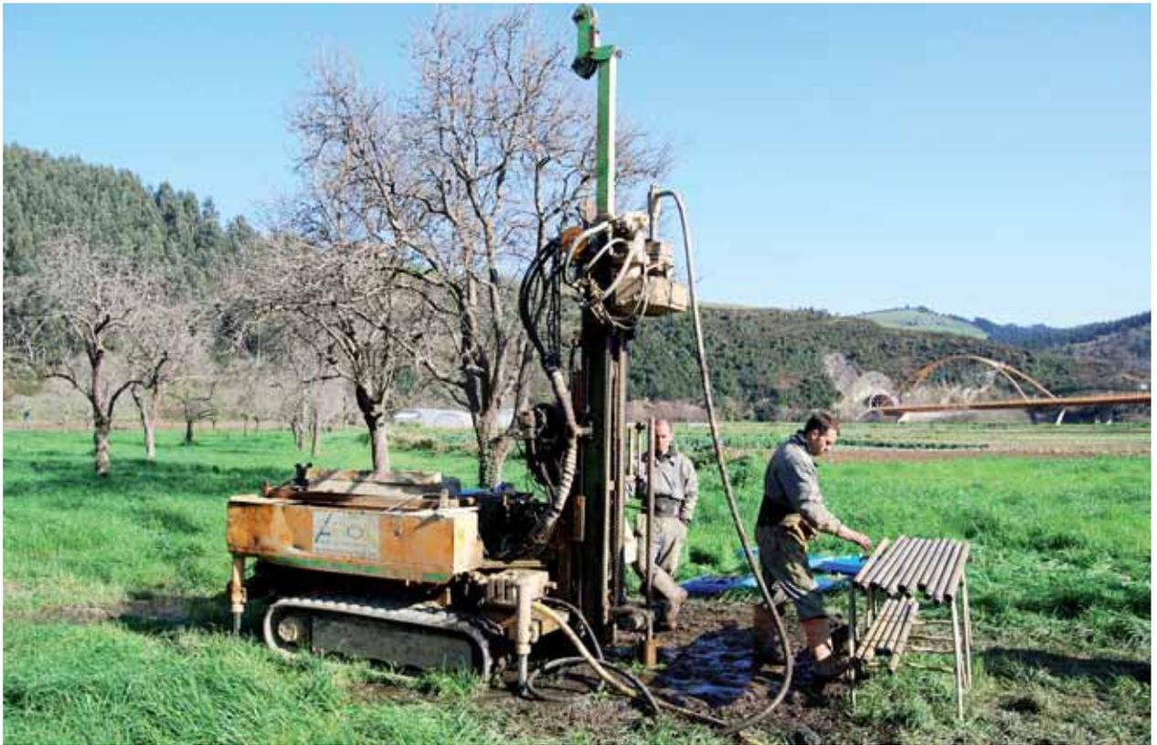
Figura 3. Sonda RL-46 perforando el sondeo DB-1 en el estuario de Deba.
