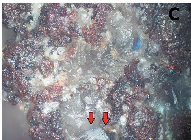
**Figura 10 (C).** PE.3- Pulido desarrollado, rugoso y abombado (200X).
