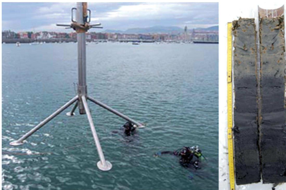
**Figura 3.** A la izquierda, el muestreador Hammer corer antes de ser sumergido en el agua para extraer los testigos. A la derecha, el testigo Abra 4 abierto longitudinalmente en el laboratorio..
