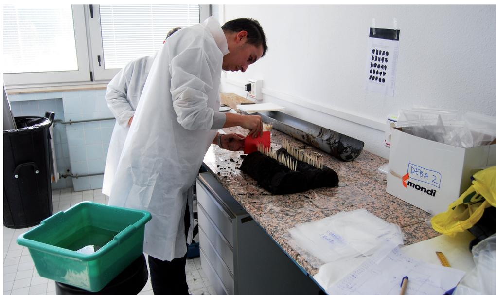
**Figura 2.** Corte del sondeo para la obtención de las muestras en el Laboratorio de Geología de la Universidad de Cantabria.
