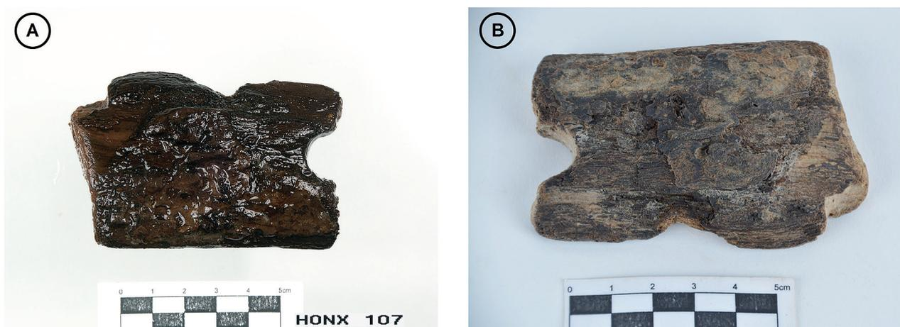
**Figura 1.** Comparativa entre pieza saturada de agua sin tratar (A) y tratada con colofonia (B).
