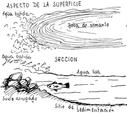
Análisis de una bolsa de agua en aguas de corriente batida y de aguas de corriente lisa.
