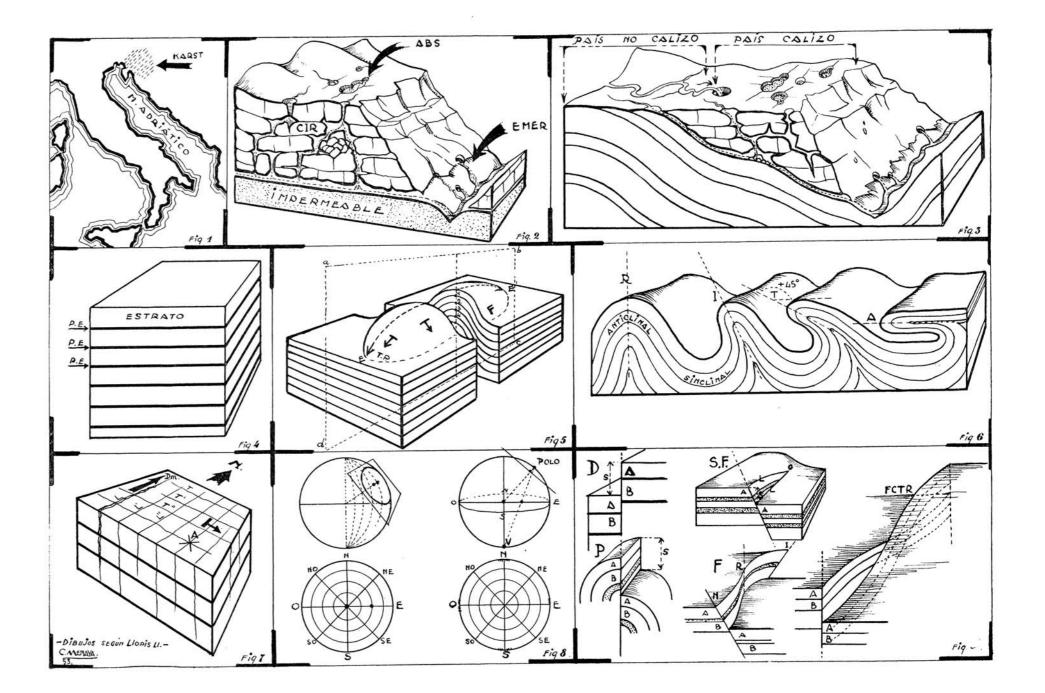
guiente una falla normal puede pasar lateralmente a falla recta y aun inversa por progresiva inclinación del plano de falla. El salto de la falla (SF) varía también constantemente desde un máximo, S, hasta cero, en cuyo caso nos hallamos en la terminación de la rotura.
