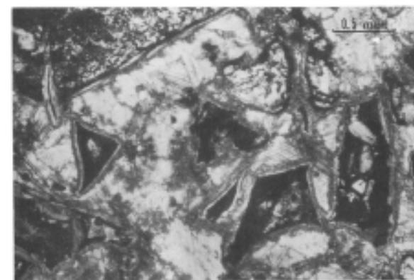
Foto 15. Cemento carbonatado en hialoclastita. S. de Aizpurucho, Km. 6 de la carretera Zumárraga-Azcoitia.
