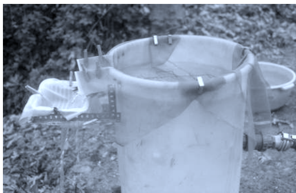
Foto 1. Máquina de flotación. Se observa la malla interior (0,5 ó 1 mm de luz) donde queda el sedimento lavado y la exterior (0.25 mm de luz) donde se recoge la muestra arqueobotánica.
