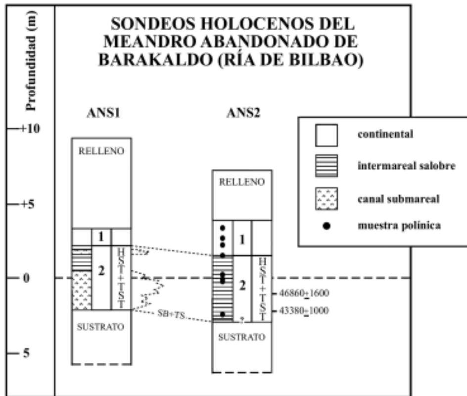
**Figura 2-20:** Interpretación paleoambiental de los sondeos del meandro abandonado de Barakaldo, basada en las asociaciones de foraminíferos. Las dataciones de radiocarbono y las muestras polínicas también aparecen indicadas. TST: cortejo sedimentario transgresivo; HST: cortejo sedimentario de nivel del mar alto. La profundidad está referida al nivel de mar local. 1-2 Asociaciones de Foraminíferos (AF).
