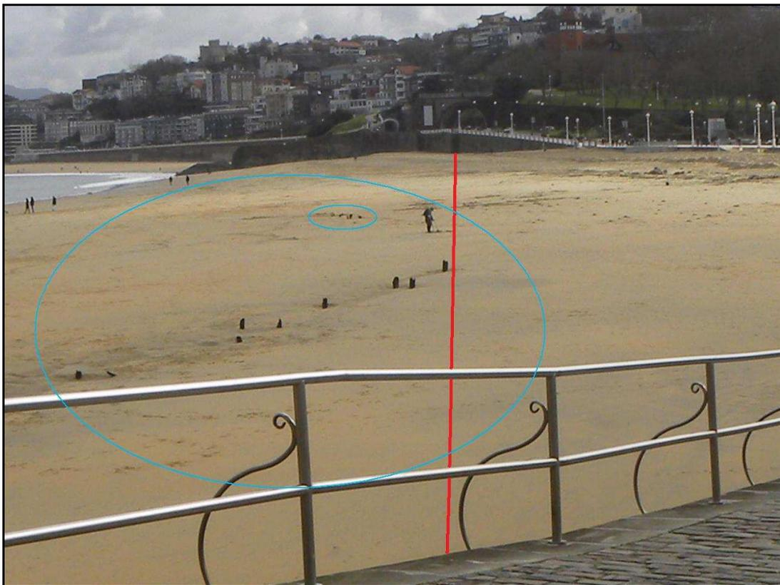
Figura 42. En rojo el trazado del muro guardamar y en azul los grupos de pilotes.
