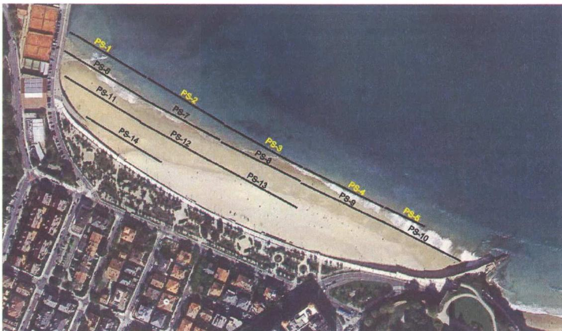
Figura 100. Representación de los perfiles sísmicos planificados (OCSA, 2015).
