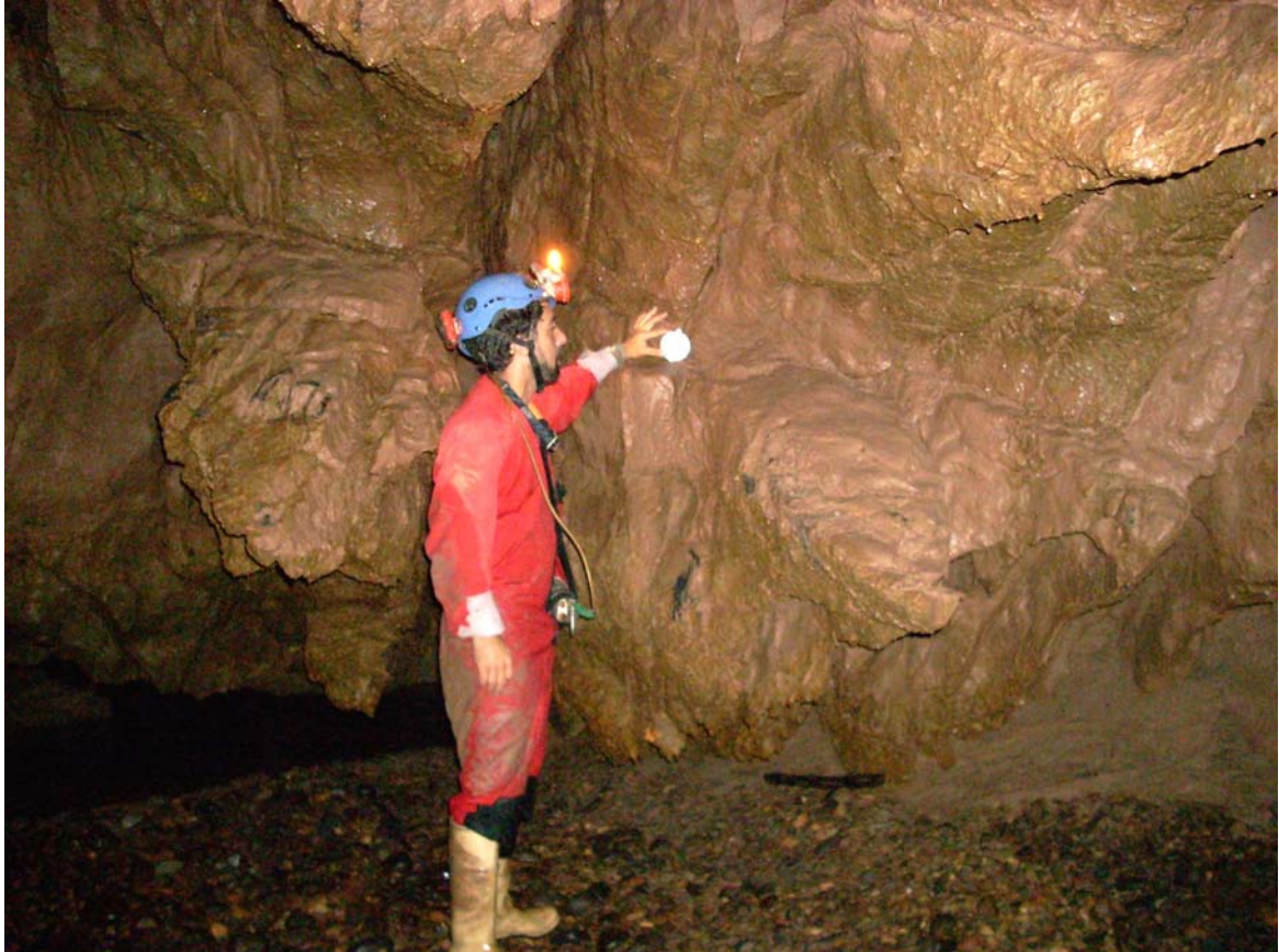
Colocación de sensores HOBO (Pro Temp/RH IS logger; Onset Computer Corp.) para registro automático de datos climáticos.
