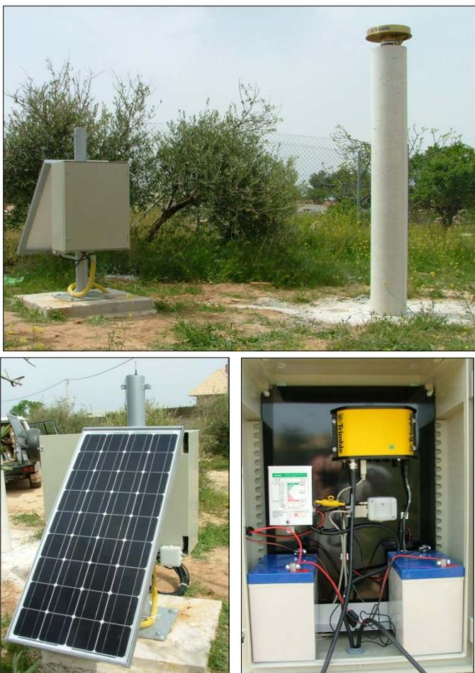
Figura 2 – Estación TGIL, vista general -arriba-, panel solar –abajo izq.- y receptor GPS –abajo dcha.- (TGIL site, general view -top-, Solar panel -bottom left- and GPS receiver -bottom right-)
