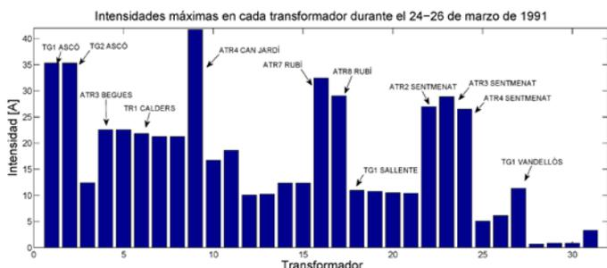
Figura 4 – GICs máximas en valor absoluto calculadas en los neutros de los transformadores de la red eléctrica de 400 kV del Noreste de España durante el periodo 24-26 de Marzo de 1991. (The maximum GICs in absolute value computed in the earthing leads of transformer neutrals of the 400 kV NE Spain power grid during 24-26 March 1991.)
