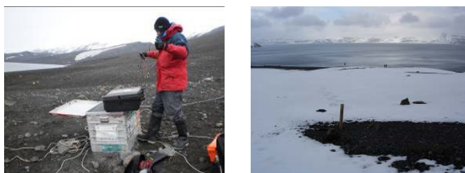
Figura 4. Instalación de una antena sísmica en el área de Bahía Fumarolas (izquierda). La estaca indica la posición de uno de los sismómetros de 12 canales de la antena sísmica (derecha). (Installation of the seismic array data acquisition system in the Fumarole Bay area (Left). Reference stake indicating the position of one of the seismometers of the 12-channel seismic array deployed in the Fumarole Bay area (right))
