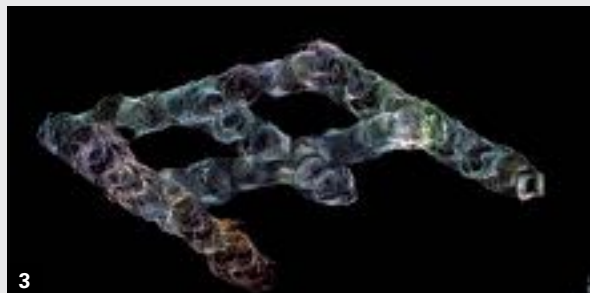
1: Fotografía del interior del Túnel-refugio de Zabalbide (Bilbao); 2: Realización del escaneado 3D en el interior del Túnel; 3: Imagen de nube de puntos del escaneado 3D del Túnel.
