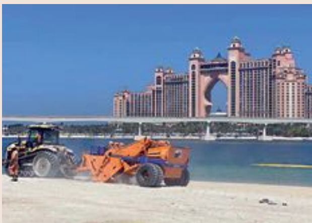
Figura 6. Despedregadora Triginer con el hotel Atlantis The Palm al fondo (03-05-2023).
