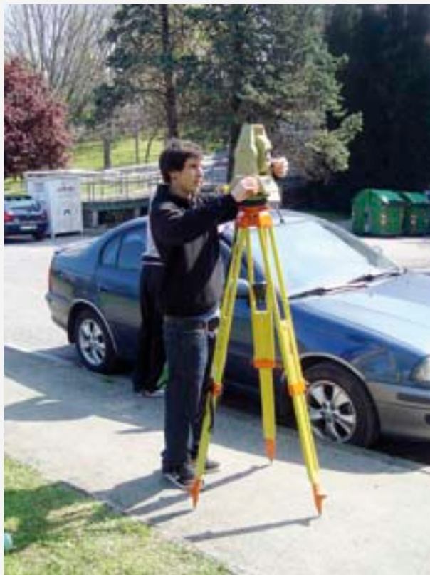
Trabajando en la nivelación en la sede antigua de Aranzadi.
