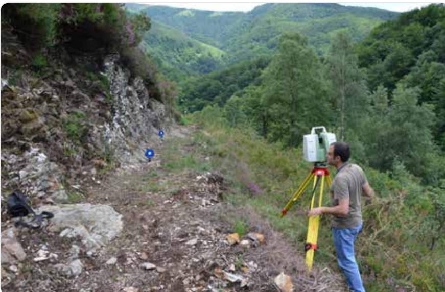
Fig. 76. Escaneo de cortes y niveles.
