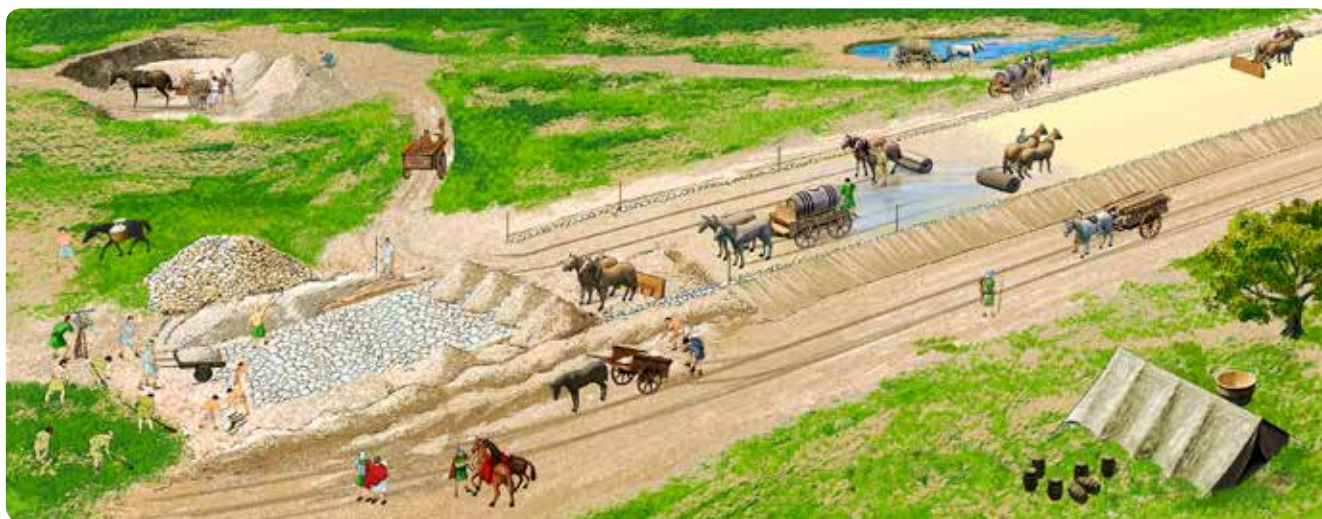
Fig. 20. Dibujo explicativo del proceso constructivo de una vía romana y los elementos intervinientes.
