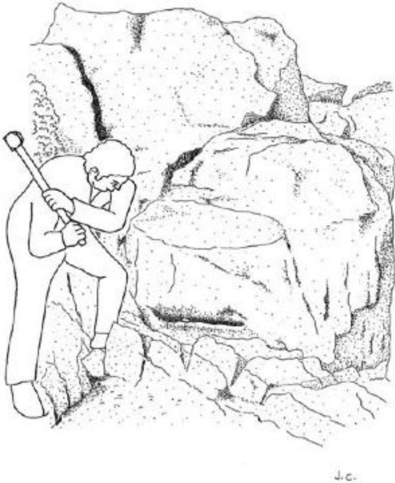
Figura 12. Dibujo de la extracción de roca mediante golpe con herramienta. Cantera de Trévago (2010).
