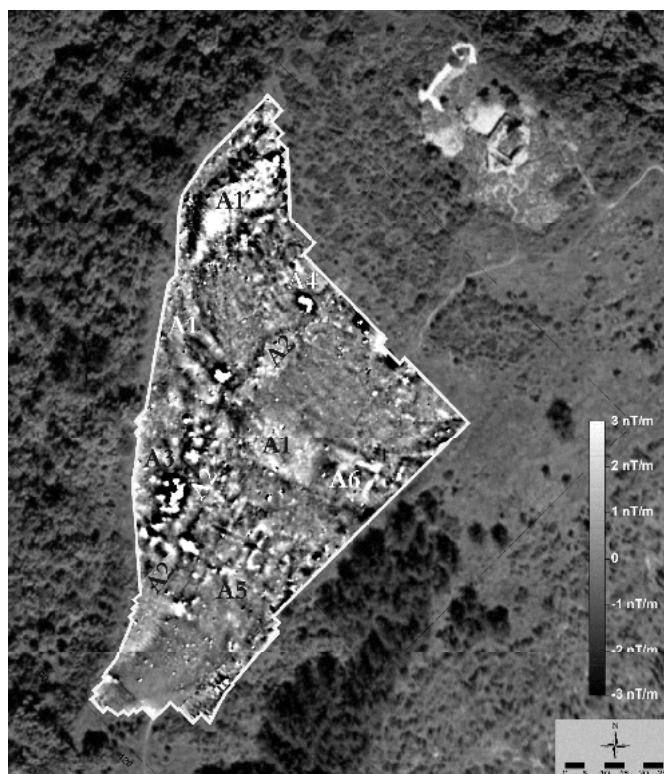
Figura 2 – Mapa de gradiente magnético ( \pm 3nT/m ) sobre imagen aérea. (Magnetic gradient map ( \pm 3nT/m ) on aerial photography).
