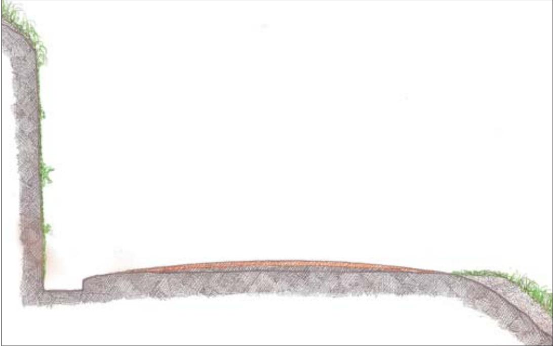
**Fig. 90.** Sección de la estructura, desmonte y cuneta excavada en la roca de esquistos. *Txoperena*.
