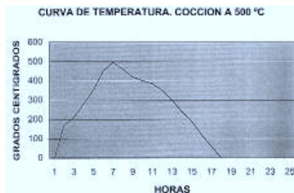
Figura 13.1. Curva de temperatura de cocción de las muestras experimentales.
