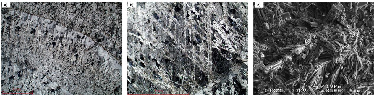
**Fig. 4. a)** Fábrica dendrítica de aragonito vista al microscopio petrográfico **b)** Detalle de los haces en abanico **c)** Cristales aciculares de aragonito vistos al microscopio electrónico (SEM).
