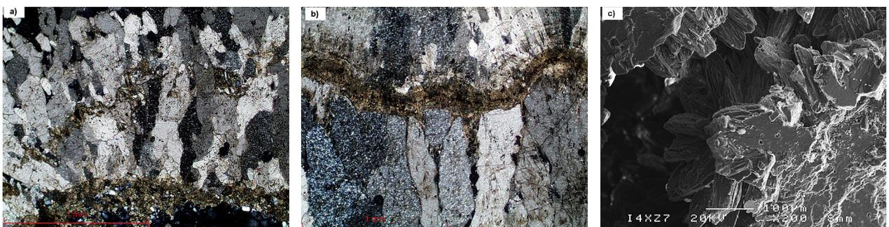
**Fig. 3.** a) Fábrica columnar de calcita vista al microscopio petrográfico b) Detalle de los cristales donde se aprecia su morfología prismática c) Cristales prismáticos vistos al microscopio electrónico (SEM).
