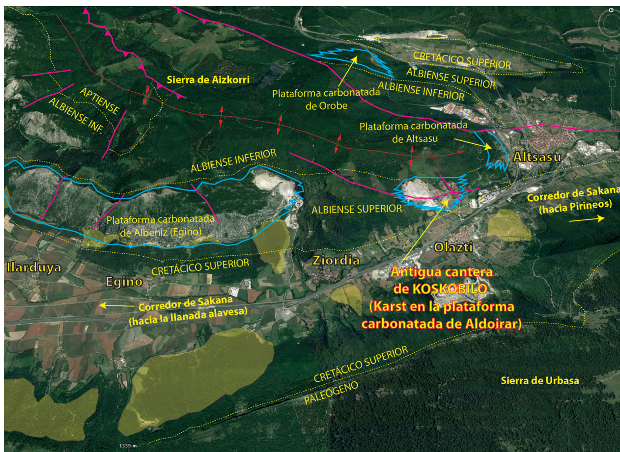
Fig. 2. Contexto geológico de la antigua cantera de Koskobilo. Esta cantera se sitúa al norte del pueblo de Olazti (Nafarroa) en el corredor de la Sakana que conecta la llanada alavesa al oeste con la cuenca de Pamplona al este. Las líneas rosas indican fallas; la línea en rojo indica el eje del anticlinorio de Bilbao. Las áreas en azul delimitan los cuerpos de calizas de plataforma carbonatada; entre estos litosomas se sitúan las margas estratigráficamente equivalentes. Las líneas discontinuas amarillas indican los contactos entre grandes unidades cronoestratigráficas. Cabe destacar la presencia de varios cuerpos de depósitos de ladera cuaternarios a ambos lados del corredor de Sakana, diferenciados en color amarillo transparente. Las fracturas principales son aproximadamente transversales y longitudinales al eje del anticlinorio de Bilbao. Imagen aérea oblicua tomada de Google Earth sobre la que se han dibujado los principales elementos geológicos y localizaciones geográficas. / Geological context of the old Koskobilo quarry, located to the north of Olazti town (Navarre) in the Sakana Corridor, a narrow valley connecting the westerly Alavan plain with the easterly Pamplona basin. Faults are represented by pink lines whereas the red one indicates the Bilbao Anticlinorium axis. Blue bordered areas represent limestone bodies separated by intervening marly areas stratigraphically equivalent. Spotted yellow lines are stratigraphical boundaries between main chronostratigraphical units. It is noteworthy that large extent bodies of colluvial deposits (yellow areas) flank both sides of the Sakana corridor. Main fracture-sets are approximately transversal and longitudinal to the Bilbao Anticlinorium axis. The aerial view obtained from Google Earth is the base for the geological mapping.
