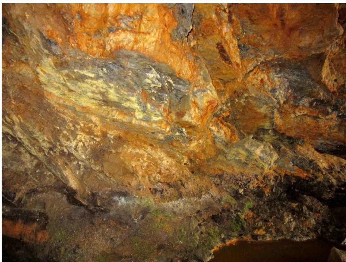
**Figura 17.** La diversidad de minerales secundarios es considerable y su distribución heterogénea. Los datos presentados se refieren a las muestras analizadas, pero puede haber más fases minerales distintas, muchas de ellas en forma de films sobre una interfase arcillosa de alteración. Igualmente hay diversos recubrimientos de microorganismos y algas verdes.
