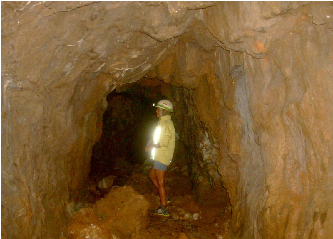
Figura 06. Pequeño lateral en la galería principal (cota -3 m) con veta de cuarzo, pequeñas espeleotemas y suelo de bloques y arcillas de descalcificación. Obsérvese la morfología de la bóveda.
